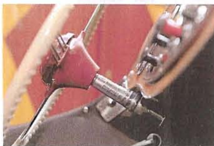
Damals wie heute ein komfortables Detail, das das Fahren angenehmer macht: die längs verstellbare Lenksäule
