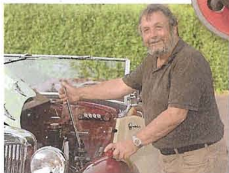
YT-Besitzer Karl-Heinz Borchers demonstriert eine Besonderheit des MG: den hydraulischen Vierstempel-Wagenheber
