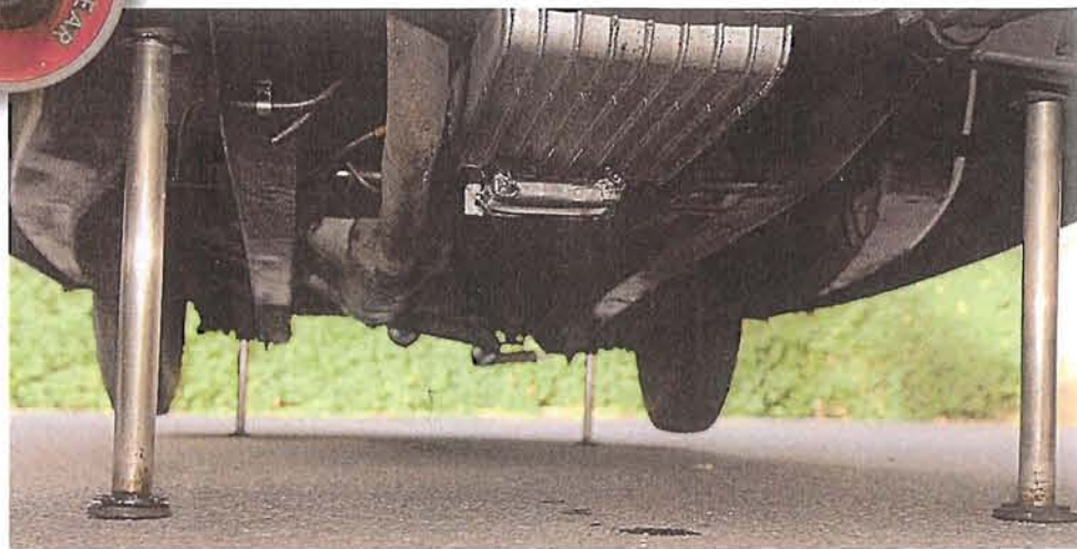
YT-Besitzer Karl-Heinz Borchers demonstriert eine Besonderheit des MG: den hydraulischen Vierstempel-Wagenheber
