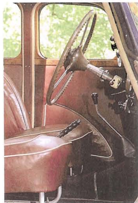
Dank hinten angeschlagener Türen kann man elegant einsteigen. Der Handbremshebel-Knopf wird zum Arretieren gedrückt
