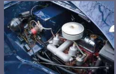
Les pièces spécifiques à la YT sont plus nombreuses qu'il n'y paraît : la caisse, bien entendu, mais aussi le capot, le pare-brise, les fixations de sièges, le filtre à air... Le pare-chocs est identique à celui de la YB. D'autres pièces sont différentes des YA/YB, mais sont souvent partagées avec les TC/TD.
