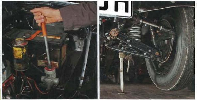
Eine praktische Besonderheit ist der fest eingebaute hydraulische Vierstempel-Wagenheber, der über eine Handpumpe im Motorraum bedient wird
