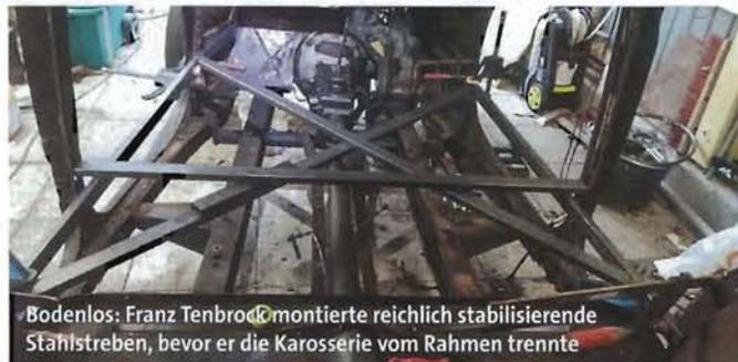
Bodenlos: Franz Tenbrock montierte reichlich stabilisierende Stahlstreben, bevor er die Karosserie vom Rahmen trennte
