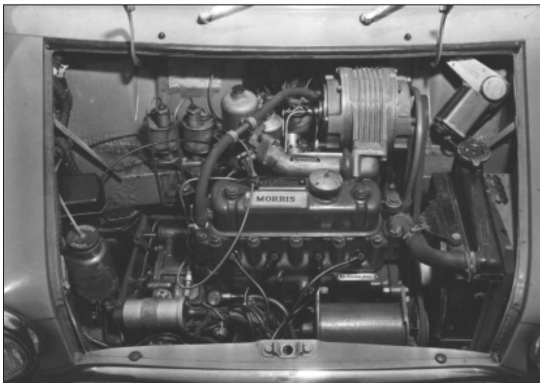
SHORROCK SUPERCHARGER C75B FITTED TO MINI ENGINE.
